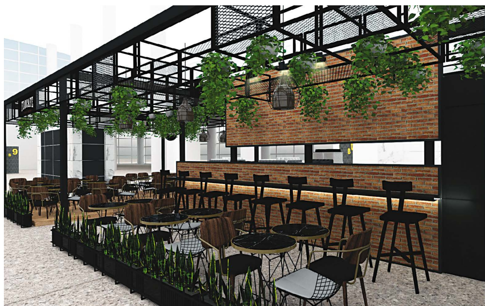
ΤΟ ΧΩΡΟΔΙΚΤΥΩΜΑ ΟΡΙΖΕΙ ΤΟ ΣΥΝΟΛΙΚΟ ΧΩΡΟ ΤΗΣ ΕΓΚΑΤΑΣΤΑΣΗΣ, ΕΞΥΠΗΡΕΤΕΙ ΤΙΣ ΑΝΑΓΚΕΣ ΤΟΥ ΦΩΤΙΣΜΟΥ ΚΑΙ ΤΗΣ ΣΗΜΑΝΣΗΣ ΚΑΙ ΠΡΟΣΦΕΡΕΙ ΤΗ ΔΥΝΑΤΟΤΗΤΑ ΠΡΟΣΘΗΚΗΣ ΔΙΑΚΟΣΜΗΤΙΚΩΝ ΣΤΟΙΧΕΙΩΝ.
